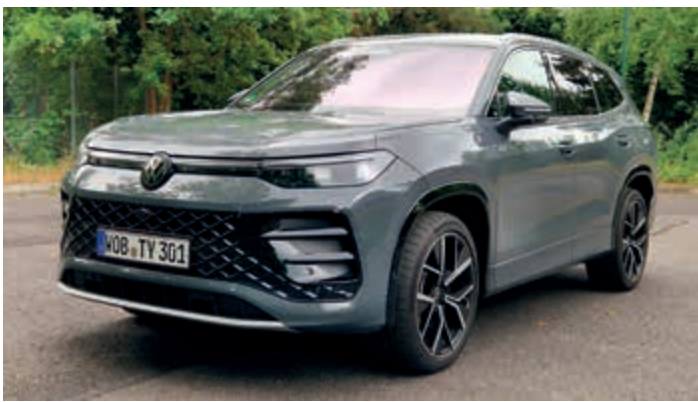
Kraftvoller Darsteller. Mittels 195 kW/265 PS starkem TSI lässt sich der bis zu 241 km/h schnelle VW Tayron in 6,1 Sekunden von 0 auf 100 km/h treiben Fotos: Access
