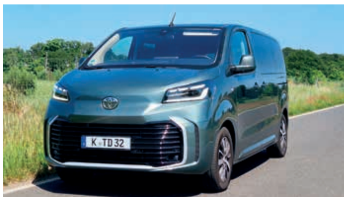
Souveräner Profi. Die 130 kW/177 PS starke 2.0-Liter Diesel-Variante des Toyota Proace Verso realisiert eine Höchstgeschwindigkeit von 185 km/h und nimmt bis zu 1,9 Tonnen Anhängelast an den Haken
