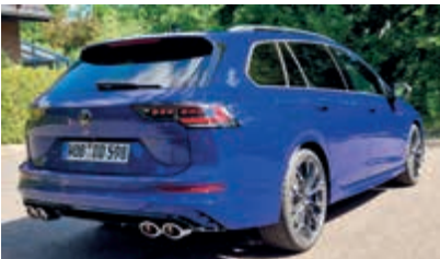
Signifikanter Leistungsspende. Die vierflüchtige, in Hochglanzschwarz gehaltene Abgasanlage des Sportkombis besitzt steuerbare Sound-Klappen
